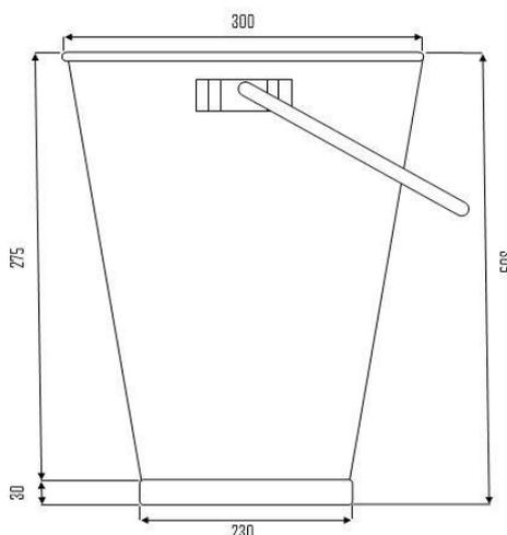
**Excelente resistencia a la corrosión, oxidación y ataque de productos químicos. Por sus características Anti chispas es ideal para plantas petroquímicas, camión de transporte de combustible, estaciones de servicio y cualquier ambiente en contacto con materiales inflamables.**
