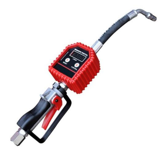
Este instrumento de medición permite un efectivo control de los movimientos de lubricantes. Es particularmente indicado para su uso en lubricentros, estaciones de servicio, concesionarias, empresas de transporte, etc. Las pistolas cuenta litros son instrumentos dotados de dos engranajes ovales y una plaqueta electrónica capaz de revelar, mediante un sensor las cantidades de fluidos que pasan a través de ellos, dándole señalización sobre un display de cristal líquido.
