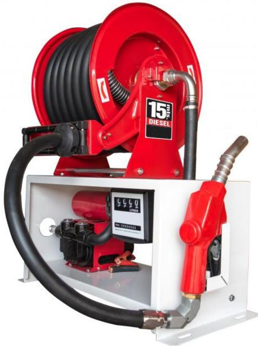
**Equipo compacto destinado al despacho de diésel, de fácil instalación para fijar en depósitos de combustible, está provisto de una electrobomba de alto rendimiento, filtro, caudalímetro de gran precisión, enrollador con 15 metros de manguera y pistola corte automático.**
